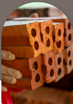
Стены межквартирные - керамический кирпич
